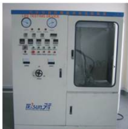
压缩机测试台
